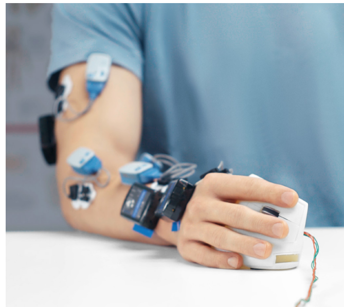
Pruebas ergonómicas de Logitech con sensores de captura de movimientos
