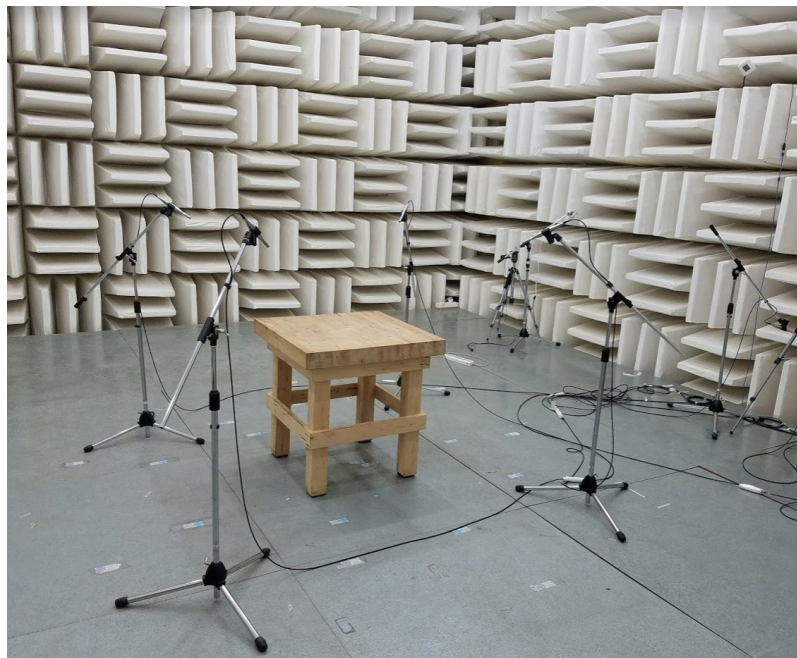
Figure 9: test de la configuration dans la chambre anéchoïque de Foxconn CMC avec un fond sonore inférieur à 6 dBA
