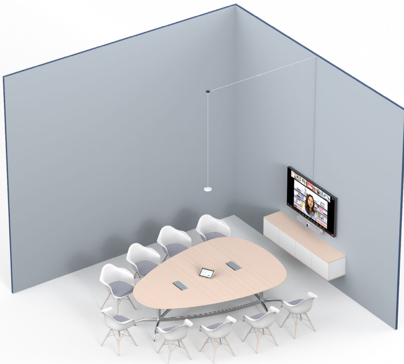
Figure 1 – Module de micro avec support de suspension. Sur cette image, le câble du module de micro est connecté à une rallonge de module de micro, qui est connectée à la Rally Bar Mini sous le téléviseur. Remarque: l'image n'est pas à l'échelle.
