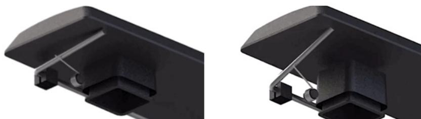
図4：トーションスプリング構造デザインによって、バランスバーとキーキャップを共にしっかりと保持することで、ノイズを軽減する
