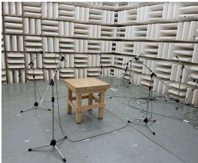
図7：Foxconn CMC無響チェンバーでの、背景雑音< 6 dBAのテスト設定
