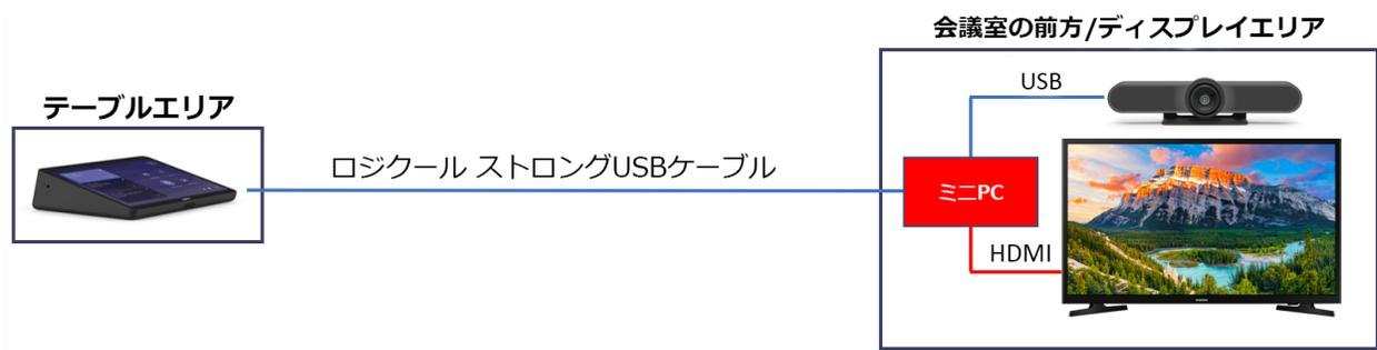
図 4 : ロジクール小会議室ソリューション - 設置図 - ロジクール Tap と MeetUp を接続
