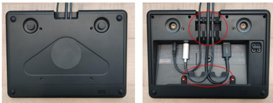
図 6 : ロジクール Tap - デバイスの背面に収まったケーブル
