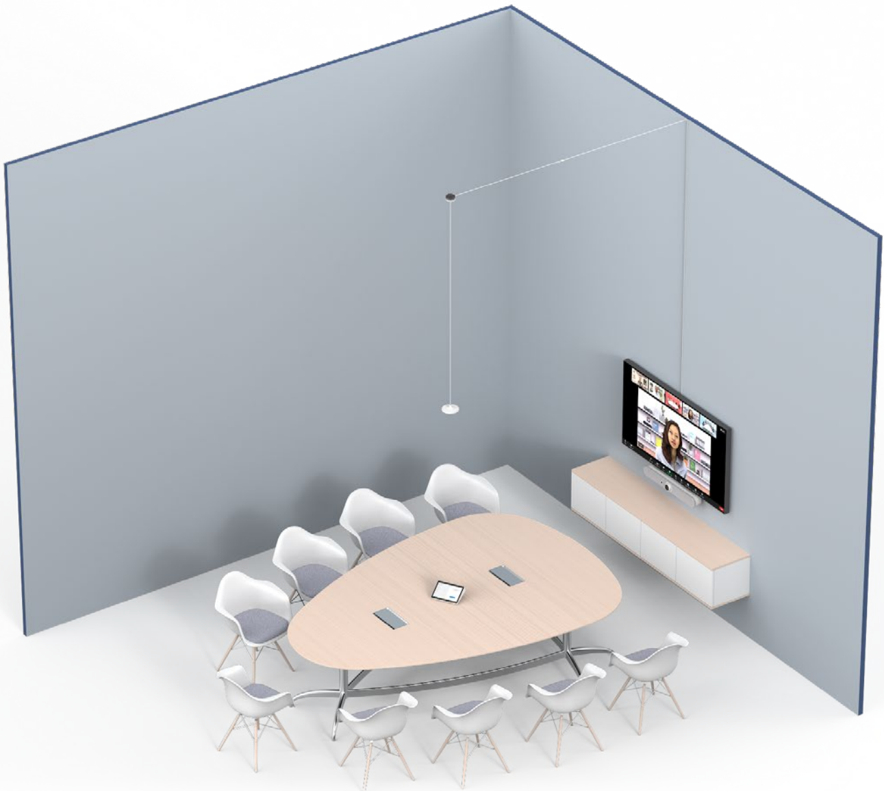
Afbeelding 1 - Een Mic Pod met hangende bevestiging. In deze afbeelding is de Mic Pod-kabel aangesloten op een Mic Pod-verlengkabel, die is aangesloten op de Rally Bar Mini onder de tv. Opmerking: Afbeelding niet op schaal.
